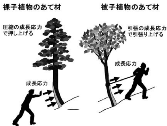
図3 樹木の幹における傾斜の回復(負重力屈性の発現)。裸子植物では、傾斜部分の二次木部の下側に沿って、一方、被子植物では上側に沿って異常な木部繊維(あて材)が形成される(樹幹下部の明るく色づけた領域)。そこには軸方向に大きな成長応力が発生し、これを利用して、傾斜して生育する樹幹や枝は負重力屈性を発現し、さらに、樹種に固有な樹形を発現する。
