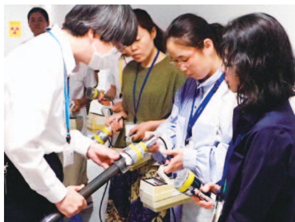
図2 1人ずつ不織布を GM サーベイメータで測定
