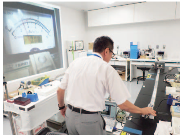
図6 ^{137}\text{Cs} 線源を用いて距離による線量の変化を測定
