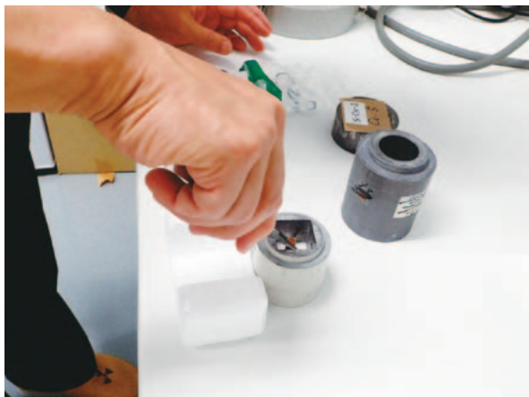
図5 ^{137}\text{Cs} 線源は小穴を開けた鉛容器に入れて使用
