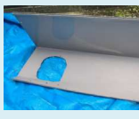
除染後のダクトの断片(丸い穴は、最初の汚染検査のために開けた穴)
